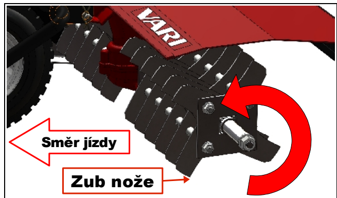
Obr. 4: Poloha nožů prořezávače (vertikutátoru) vůči směru jízdy a směru otáčení
