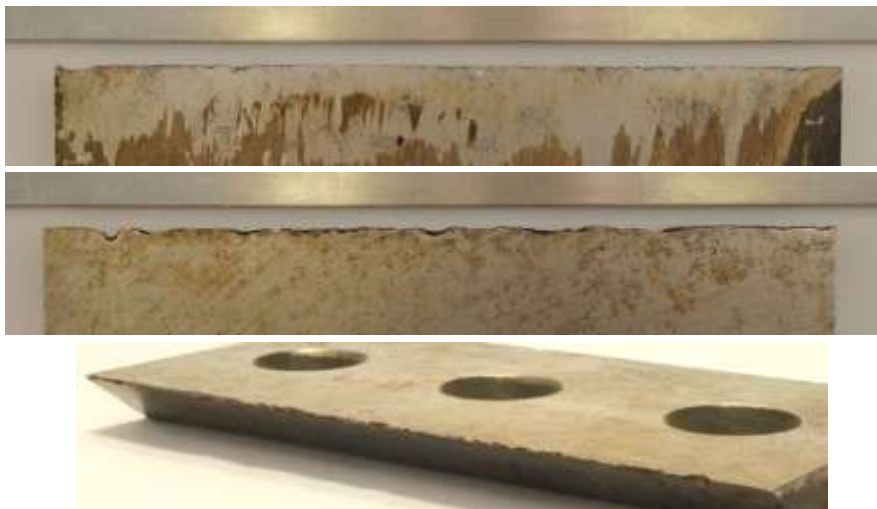
Ostří nože otupené po nárazech na tvrdé materiály
