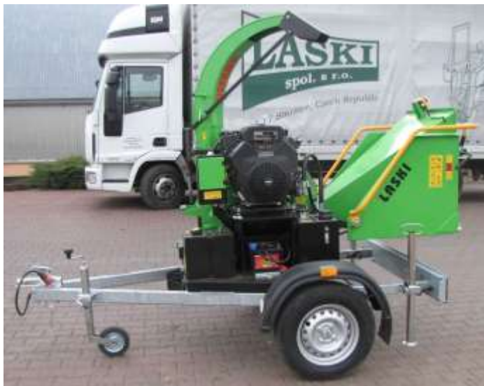
Přepravní poloha štěpkovače Odváděcí žlab sklopen do středu stroje
