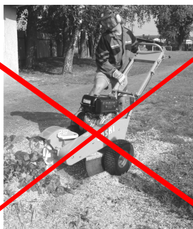
Ovládní stroje z boku – zakázaný způsob ovládní
