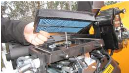
molitanová vložka a papírová vložka filtru
