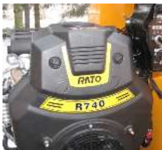
Plášť filtru u motoru Rato
