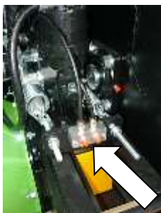
Maznice suvného vedení vkládacích válců a maznice ložiska vkládacích válců Mazání po 40 hodinách provozu (týdně) (LTA 3EP MOL Liton)
