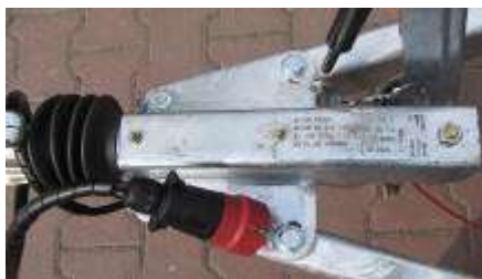
Maznice na tažném oji Provádějte mazání při ujetí 10000 – 12000 km nebo po 12 měsících (LTA 3EP MOL Liton)
