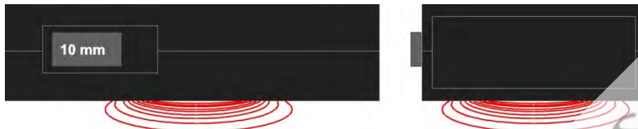
pohled ze strany: měřené pole a hloubka měření při nastavení přepínače „10 mm“
