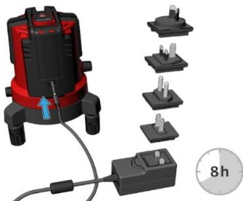
Před prvním použitím dobijte Li-Ion baterii. Příklad se může během dobíjení zahřívat. Jedná se o běžný jev neovlivňující životnost ani výkon přístroje. Při doporučené teplotě uskladnění -20 °C až +30 °C (-4 °F až +86 °F) je možné skladovat baterie nabitě na 50 % až 100 % po dobu až 1 roku. Po této době musejí být baterie znovu dobity.
