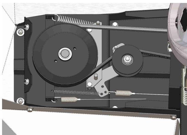
Obr. 11: Kladka spojky pohonu disku - brzda
