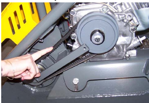
Obr. Kontrola napnutí klínového řemenu
