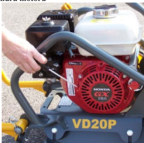
Obr. Povytažená startovací šňůra motoru
