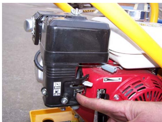
Obr. Zavřený palivový kohout motoru
