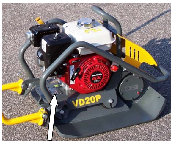
Obr. Umístění výrobního štítku stroje
