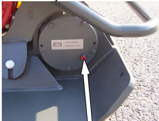
Obr. Plnicí, kontrolní a vypouštěcí zátka oleje vibrátoru
