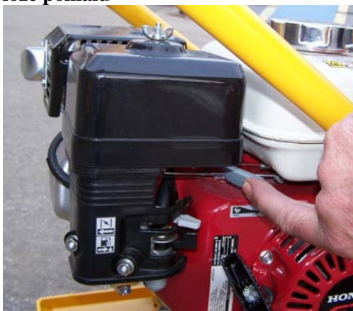
Obr. Páka plynu motoru v poloze pomalu
